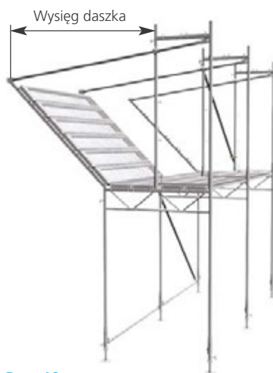
Rys. 19. Przykład daski ochronnego w rusztowaniach systemowych.
